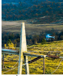
OVERVÅKER: eSmart benytter droner som automatisk kan gjenkjenne feil eller skader i kraftnett. FOTO: ESMART SYSTEMS
